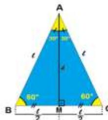
Figura 14 – Cálculo do seno, cosseno e tangente ângulos 30° e 60°
